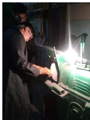
Рис. 5. Подготовка костного материала к испытанию на сжатие.
