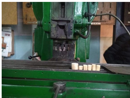
Рис. 5. Подготовка костного материала к испытанию на сжатие.
