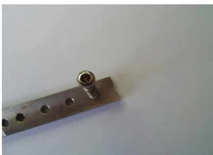
Рис. 9,10. Повреждение поверхностного защитного слоя металлоконструкции из-за грубых манипуляций хирурга при моделировании.
