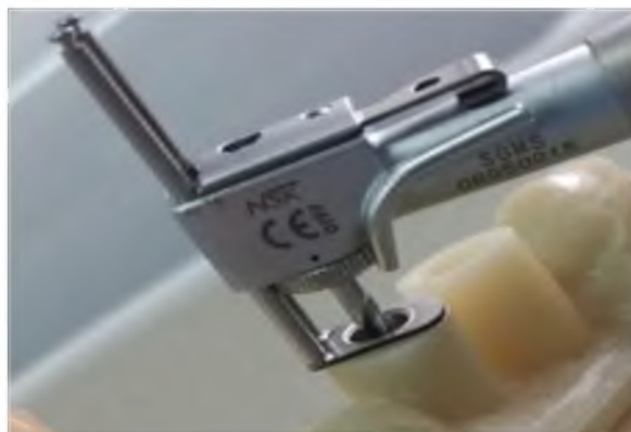
Рис. 10. Проверка диаметра отверстий.
