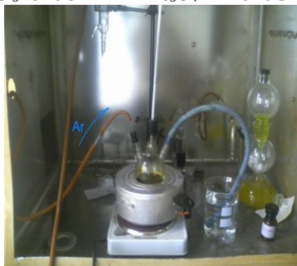
Рис. 1. Получение нанокомпозита \text{Fe}_3\text{O}_4\text{-ГК} методом химического соосаждения
